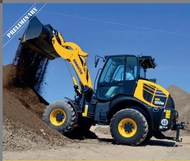
ENGINE POWER 69,8 kW / 93,6 HP @ 2.000 rpm **OPERATING WEIGHT** 6.925 - 7.230 kg **BUCKET CAPACITY** 1,05 - 1,8 m<sup>3</sup>
